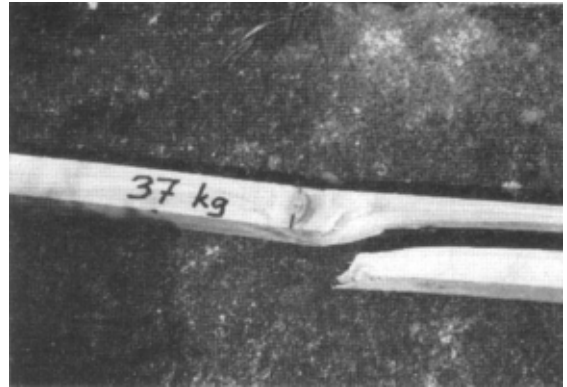
Test d'un sciage défectueux: la résistance atteint seulement 25 % de la charge de rupture spécifique obtenue à partir de 6 essais menés sur des membrures saines.
